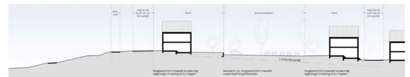
Principedoorsnede van de Dorpskern op de Klimaatdijk
